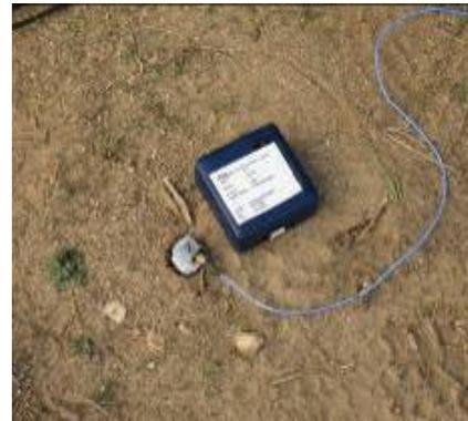
Figura 1. Mediciones del nivel vibratorio actual antes de la nueva infraestructura
