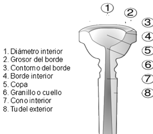
Figura 1. Esquema genérico de una boquilla de instrumento de metal.
