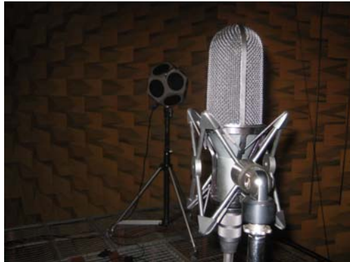
Figura 3. Calibración de la cadena de medida en la cámara anecoica.
