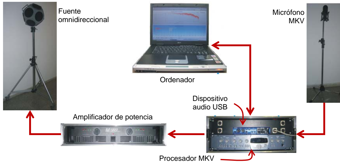
Figura 1. Esquema del sistema de medida.
