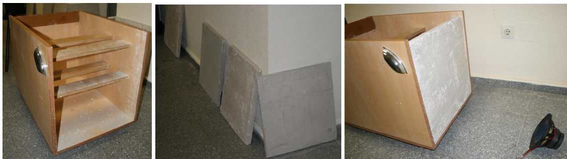
Figura nº1: caja anecoica (izquierda), pantallas de hormigón a escala (centro), colocación pantalla-caja anecoica frente a fuente de ruido (derecha)
