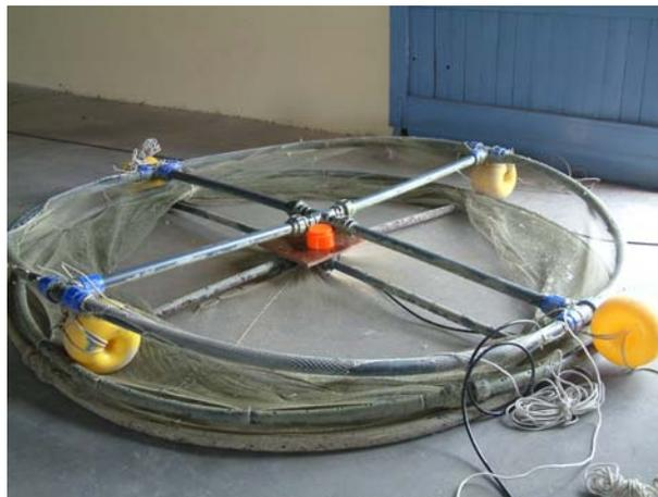
Fig. 1. Detalle de montaje del transductor en el fondo de la jaula.
