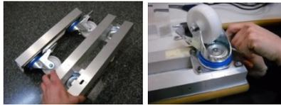
**Figura. 2a. Preparación del sistema de ruedas que soportará el porta-muestras**
