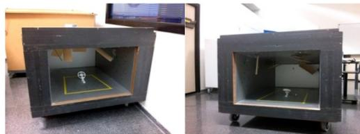
**Figura. 5. Paneles difusores colocados en recinto emisor y receptor.**
