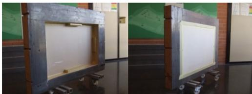
**Figura. 4. Elemento de separación instalado en porta-muestras**
