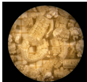
Figura 1.- Vermiculita tipo 2 tomada en lupa (x2 aumentos)
