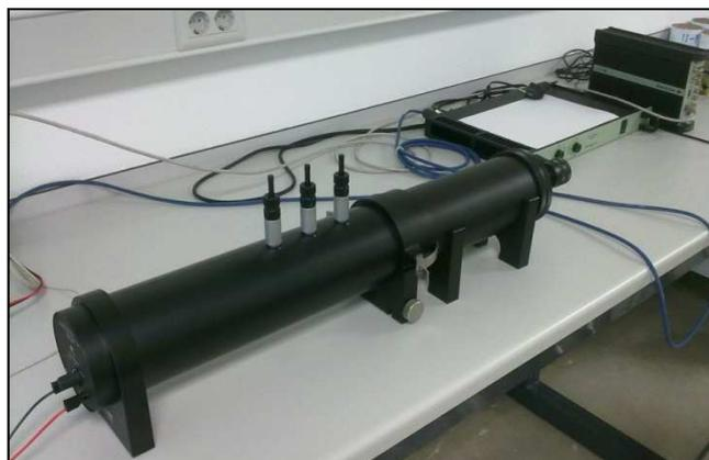
Figura 5. Tubo de impedancia
