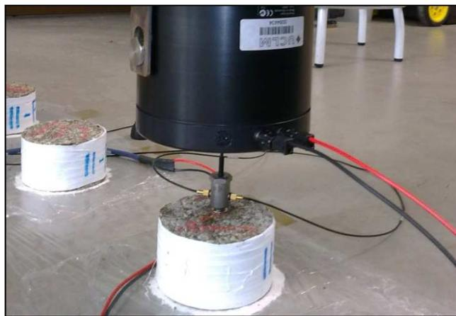
Figura 2. Excitador de vibraciones
