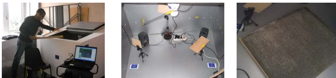
Figura 4. Imágenes de la cámara reverberante a escala y alguno de los ensayos realizados.
