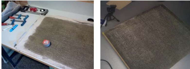
Figura 5. Diseño y prototipo de barrera acústica elaborada con el Composite Textil perforado.
