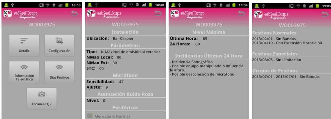
Puede acceder a los datos del limitador instalado, a su configuración, a los niveles de presión existentes, bandas horarias, a las incidencias y posibles manipulaciones y número de personas
