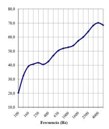
Aislamiento global calculado según la Norma ISO 717-1:1996: Rs w (C;Ctr) = 50 (-4;-11) dB Aislamiento global en dBA (entre 100 y 5000 Hz): Rs A = 47,5 dBA
