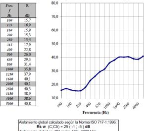
Rs w (C;Ctr) = 29 (-1;-5) dB niento global en dBA (entre 100 y 5000 Hz):
