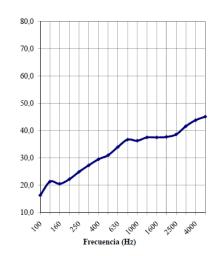
Aislamiento global calculado según la Norma ISO 717-1:1996: Rs w (C;Ctr) = 35 ( -2 ; -5 ) dB Aislamiento global en dBA (entre 100 y 5000 Hz): Rs A = 34,3 dBA
