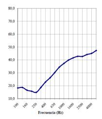
Aislamiento global calculado según la Norma ISO 717-1:1996: Rs w (C;Ctr) = 30 (-2;-5) dB Aislamiento global en dBA (entre 100 y 5000 Hz): Rs A = 29,1 dBA
