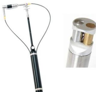
Fig. 1 Izda. Sonda P-P; Dcha: sonda P-v
