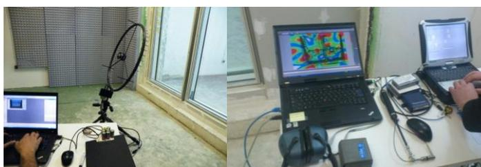
Fig. 5 Evaluación de puentes acústicos en un muro cortina
