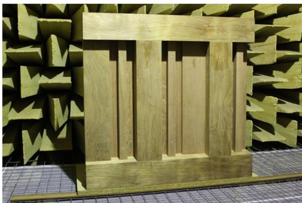
Figura 2 – Painel difusor de madeira do tipo QRD7 modificado
