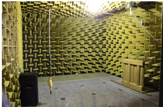
Figura 6 – Montagem experimental – painel difusor “hemicilindros” – incidência a  $0^\circ$
