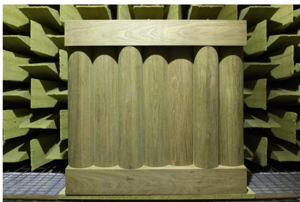
Figura 3 – Painel difusor de madeira do tipo hemicilindros
