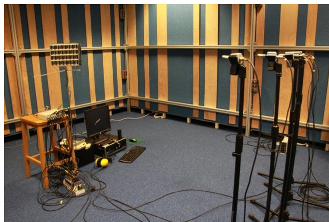
Figura 6. Conformador dentro de la sala acondicionada para la escucha de audio, junto con el set-up usado en las medidas.
