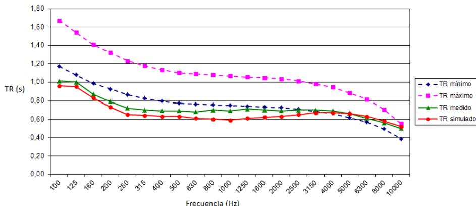
Figura 3. Validación del modelo con el tiempo de reverberación medido
