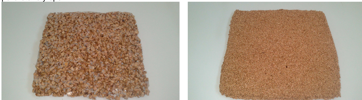
Figura 1. Detalle de algunas de las diferentes láminas empleadas en este trabajo. A la izquierda lámina de corcho aglutinada con resina epoxi y 4,0 < D < 5,0 mm. A la derecha lámina de corcho aglutinada con resina poliuretano y 1,0 < D < 2,0 mm.
