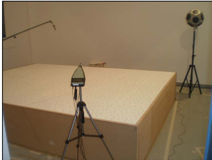
Imagen 1: Muestra instalada sobre el suelo con plenum.
