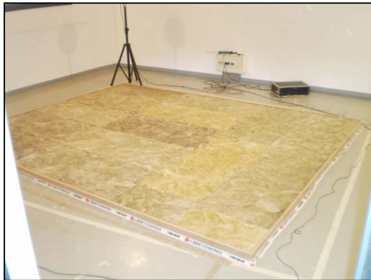
Imagen 2: Muestra instalada directamente sobre el suelo.
