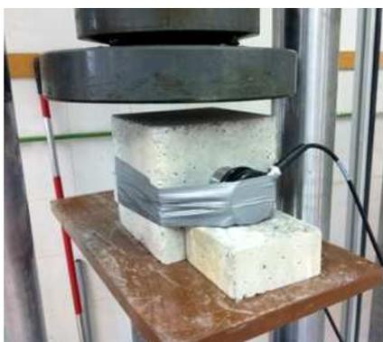
Figura 3. Fotografía del dispositivo antes de la realización del ensayo de rotura.
