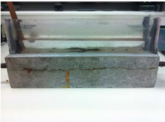
Figura 7: Imagen de la macrofisura longitudinal generada.
