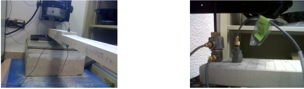
Figura 4. Medida de la vibración en las vigas
