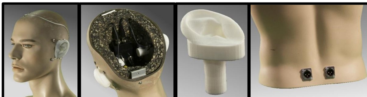
Figura 1 – HATS, detalles de conexionado y oreja artificial.
