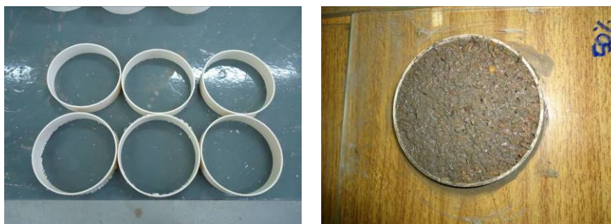
Figura 5: Moldagem dos CPs: Moldes de PVC utilizados para a confecção dos CPs (esq) e CPs recém-moldados, observando-se a lamina de vidro utilizada como base (dir).
