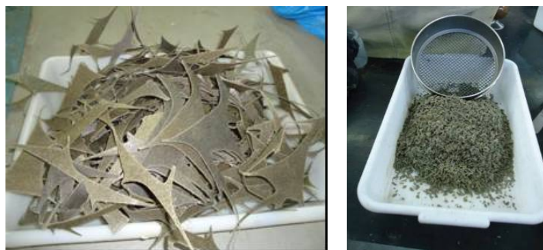
Figura 3: Resíduo de contraforte termoplástico: resíduo recebido (esq) e após a trituração (dir).
