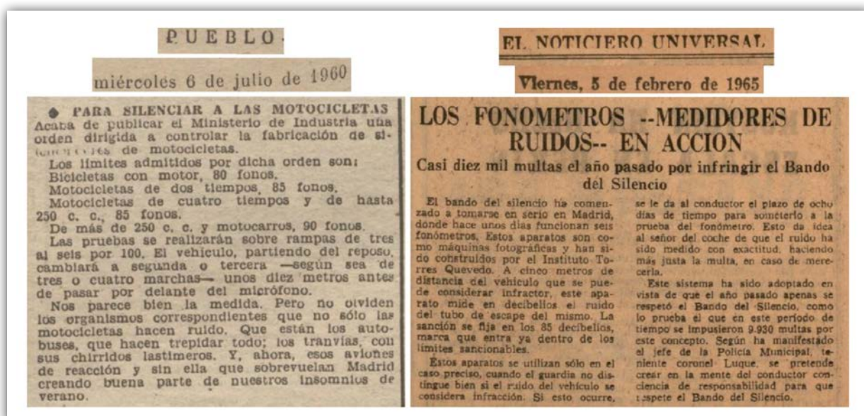
Figura 5. a) Límites de ruido para motocicletas de 1960 en unidades de fonos; b) Uso de fonómetros del Instituto «Torres Quevedo» para mediciones de ruido mencionando unidades en decibelios en 1965.
