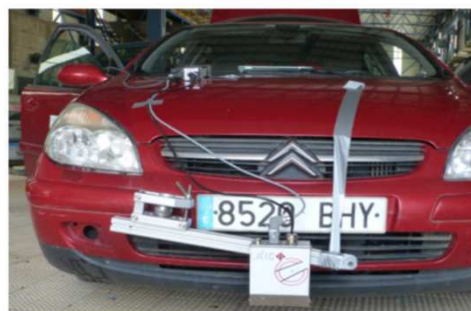
Figura 2.- Detalle del perfilómetro Laser del equipo LaserDynamicPG-LA 2 IC.
