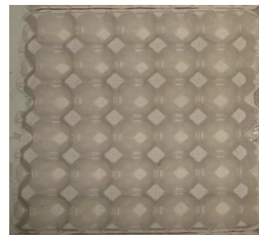
Fig. 4 e 5 – T30A-n-ESP (esq.) -Tabuleiro para 30 ovos com pequenas Aberturas (superfície normal voltada para cima) sobre placas de ESPuma de 30 mm de espessura; (dir.) T30-n - Tabuleiro para 30 ovos (superfície normal voltada para cima).
