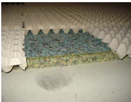
Fig. 4 e 5 – T30A-n-ESP (esq.) -Tabuleiro para 30 ovos com pequenas Aberturas (superfície normal voltada para cima) sobre placas de ESPuma de 30 mm de espessura; (dir.) T30-n - Tabuleiro para 30 ovos (superfície normal voltada para cima).
