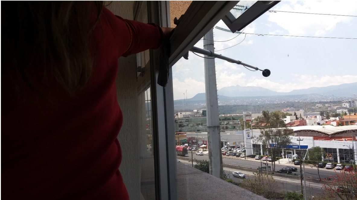
Figura 4. Posición del micrófono para medición de ruido vehicular a 2m frente de la fachada
