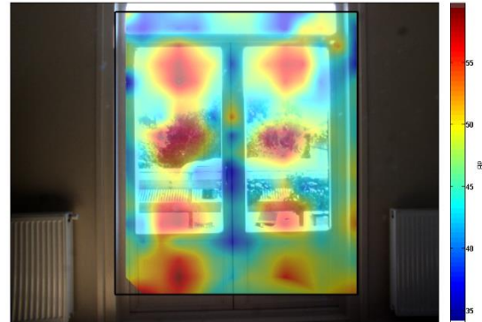
Figura 5. Mapa de distribución de la velocidad de partícula 165 Hz
