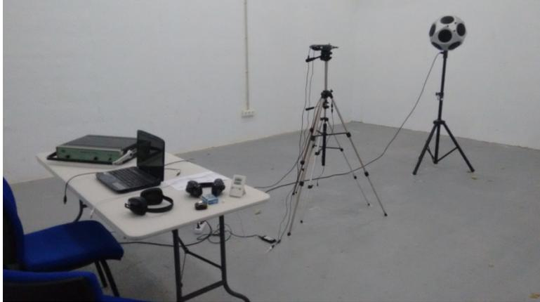
**Imagen 1:** Interior de la cámara reverberante de la Universidad de Extremadura (Escuela Politécnica, Cáceres) con los instrumentos empleados en la medición.
