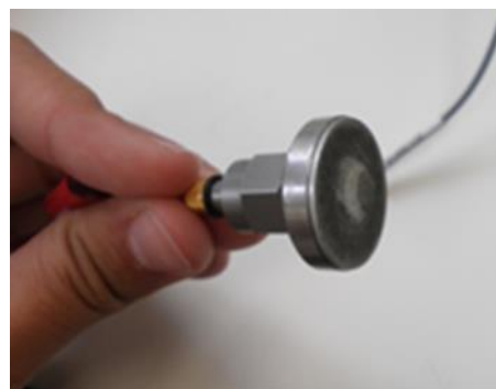
Figura 3. Acelerómetro piezoeléctrico con imán acoplado utilizado como sensor de vibraciones.
