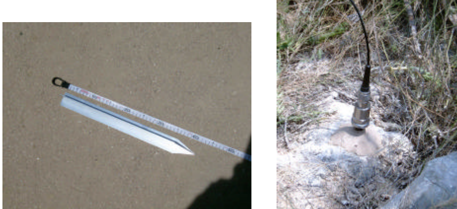
Figura 2: Estacas y acelerómetros de medida
