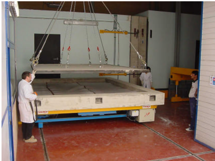
Cámaras acústicas móviles del Laboratorio de Control de Calidad de la Edificación del Gobierno Vasco
