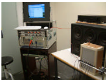
Figura 2. Montaje de medida de NAH
