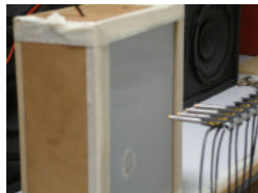
Figura 3. Altavoz de policarbonato y array de micrófonos
