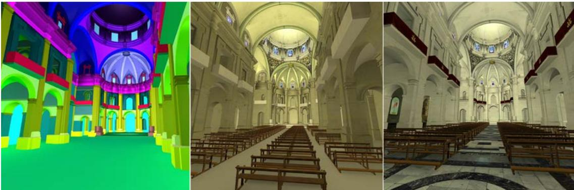
Figura 6. Evolución del proceso de texturización de la Basílica de Santa María de Elche, desde el modelo geométrico y la sucesiva incorporación de elementos.
