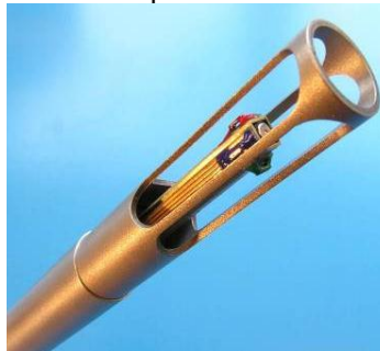
Figura 1. Sonda USP, formada por tres sensores de velocidad y uno de presión.
