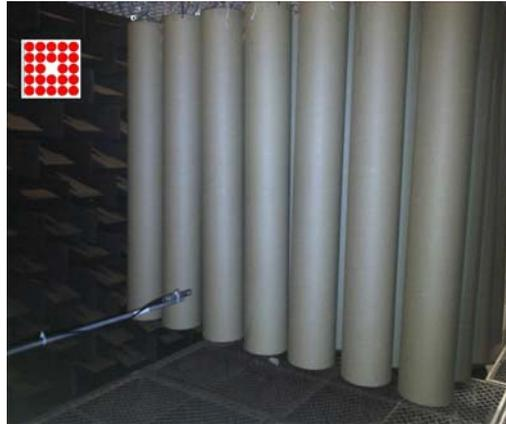
Figura 4.- Cristal de sonido. El inset corresponde a la planta de dicho cristal donde se muestra la vacante creada. Las características del cristal son: simetría cuadrada,  $a = 22$  cm y radio de los cilindros  $r = 10$  cm.
