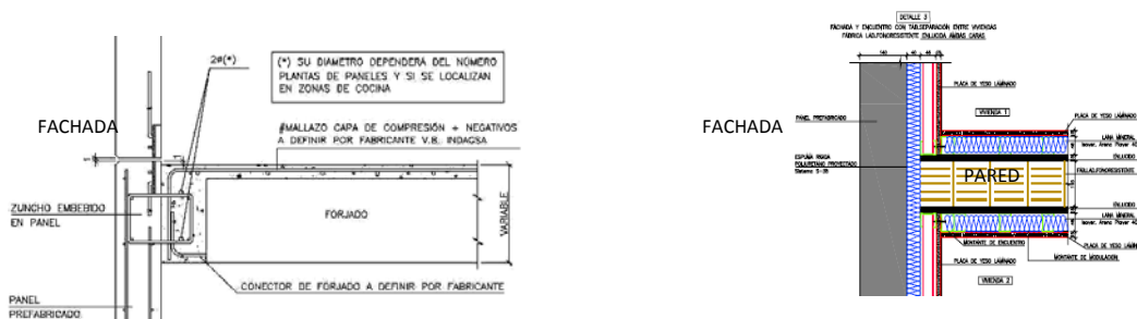
Figura 4. Detalle de los encuentros en obra panel-forjado y panel-pared. Promoción de viviendas ubicada en Móstoles.
