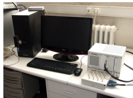
Figura 4. Vista del la parte de monitorización y control del nuevo sistema de análisis no lineal de transductores de potencia
