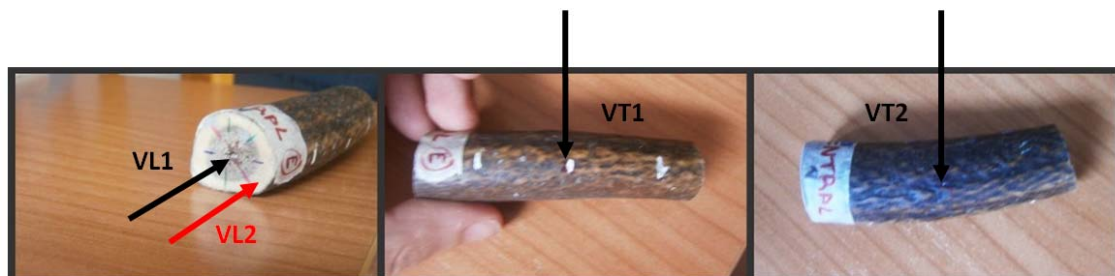
Figura 3: Diferentes ejes de las piezas sobre los que se ha medido la velocidad de transmisión de la onda.
