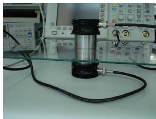
Figura 2b: Configuración con los dos transductores enfrentados y un vidrio monolítico intermedio
