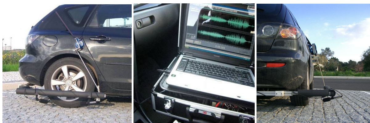
Figura 4 – Sistema de aquisição usado no ensaio CPX.
