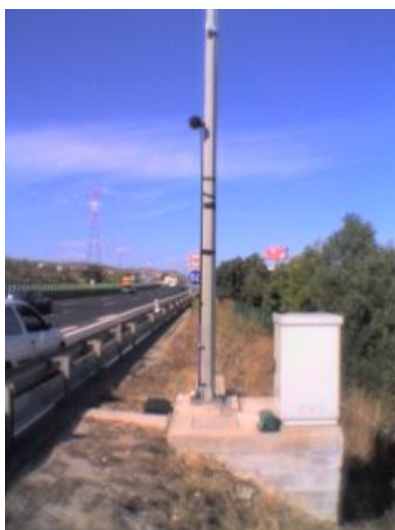
Figura 5 – Vista de uma estação de monitorização contínua de ruído junto a auto-estrada.
