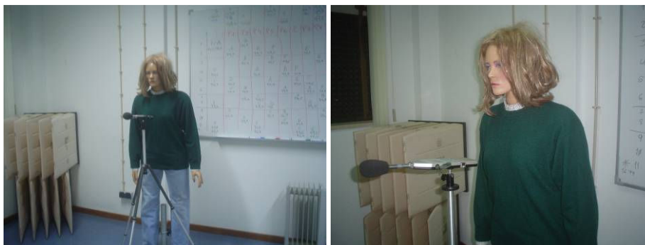
Figura 7 – Manequim “operador” no interior da sala receptora durante a medição
