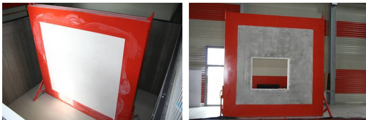
Figura 6 – Aspecto dos aros de provetes de ensaio: a) aro com provete de alvenaria revestida a gesso projectado para ensaio; b) aro usado para ensaio de isolamento a sons aéreos de janelas e envidraçados.
