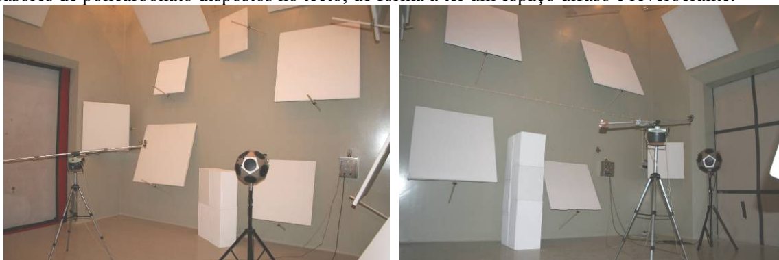
Figura 4 – Câmaras horizontais após a correcção dos tempos de reverberação: a) câmara emissora; b) câmara receptora.
