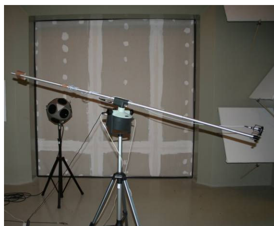
Figura 7 – Parede do tipo A: a) provete instalado entre as câmaras horizontais; b) composição do provete leve.
