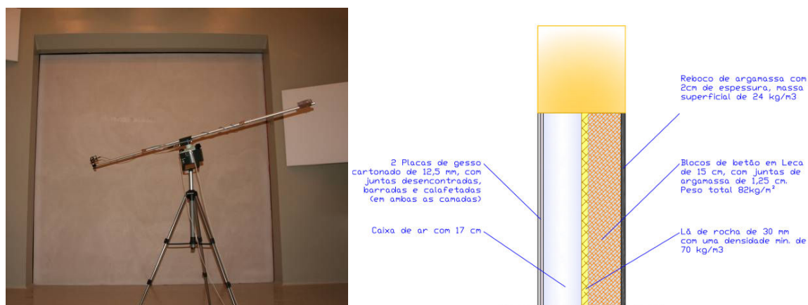
Figura 8 – Parede do tipo B: a) provete instalado entre as câmaras horizontais; b) composição do provete de alvenaria leve.
