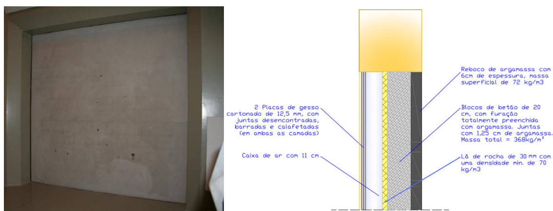
Figura 9 – Parede do tipo C: a) provete instalado entre as câmaras horizontais; b) composição do provete de alvenaria pesada.
