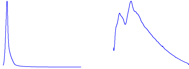
Figura 2. Respuesta en frecuencia de un sistema con un solo grado de libertad (derecha) y respuesta en frecuencia de un sistema con dos resonancias cercanas (izquierda).
