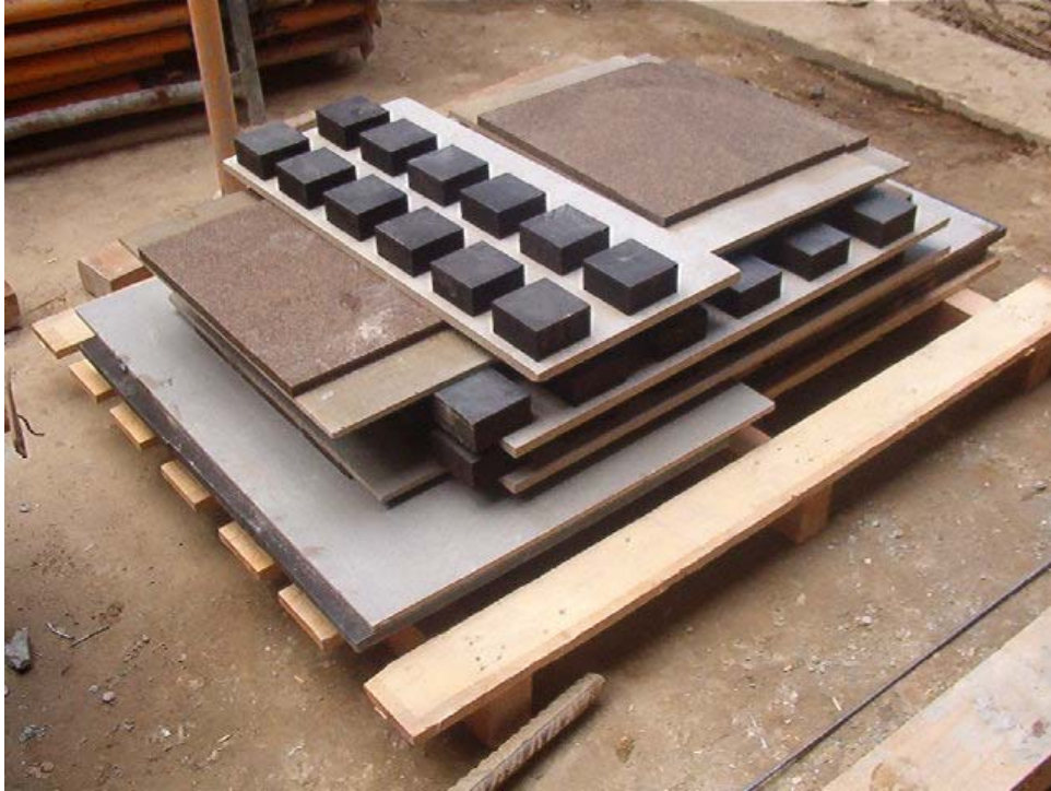
Figura 3 – Apoios resilientes prontos para aplicação
