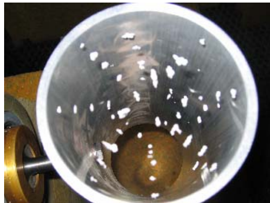
Figura 3. Disposición del lecho fluido en el interior del cilindro cuando se aplica potencia al transductor.
