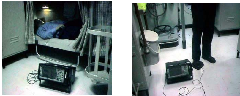
Figura 4 – Medição de vibrações com a pessoa deitada e em pé
