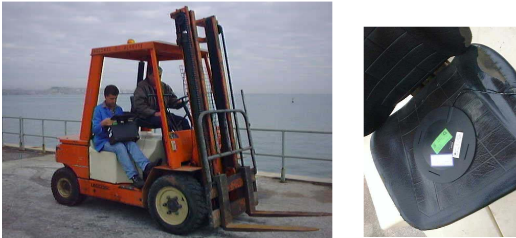
Figura 6 – Trabalhador a conduzir um empilhador e a localização do sensor no assento
