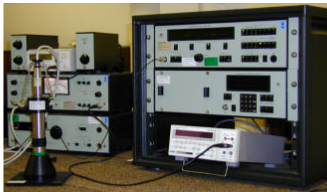
Figura 2– Método de aplicação de tensão para a calibração de pistãofones
