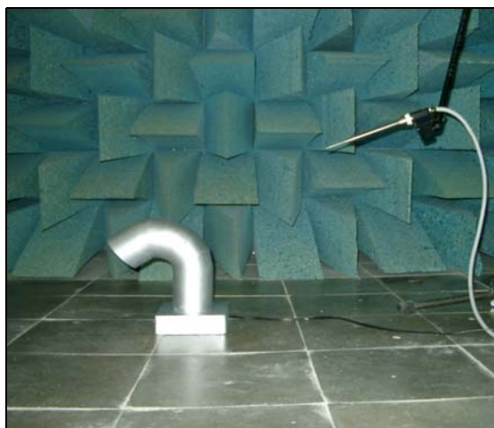
Figura 4. Mediciones en cámara semianecoica con maqueta a escala reducida 1:8
