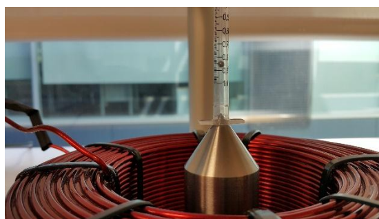
Figura 4. (Izquierda) Imagen 2D de la simulación con Comsol de los valores de la norma de H y las flechas de campo magnético. (Derecha) Experimento de medida de la fuerza magnética sobre la esfera.
